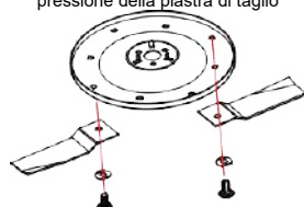
Rimuovere le due viti di bloccaggio della lama M10 e i cuscinetti a molla per completare lo smontaggio.
