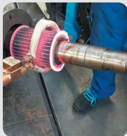
Riscaldamento di un ingranaggio : - Induttore ad anello L180 - Powerduction 220LG
