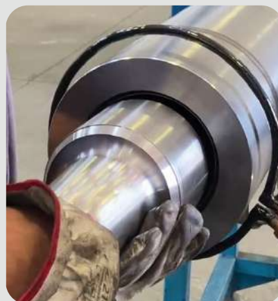
Calettamento di un cilindro per cilindri idraulici - Induttore ad anello L20/D200 - Powerduction 220LG
