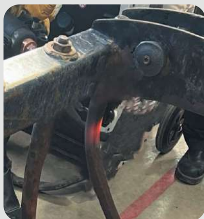
Raddrizzamento dei denti della benna : - Induttore Large L20B4 - Powerduction 220LG
